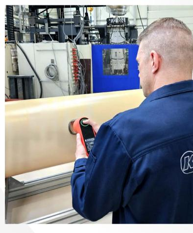
Das WARP portable ist ein mobiles, intuitiv nutzbares Handmessgerät zur punktuellen Wanddickenmessung. Es nutzt ein radargestütztes Messprinzip, um die Wandstärke der produzierten Teile präzise und zuverlässig zu erfassen.
