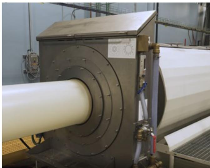
*Das iNOEX-Ultraschallmesssystem befindet sich direkt außerhalb des Vakuumtanks. Es liefert präzise Dimensionsdaten, die in den geschlossenen Regelkreis eingespeist werden.*
