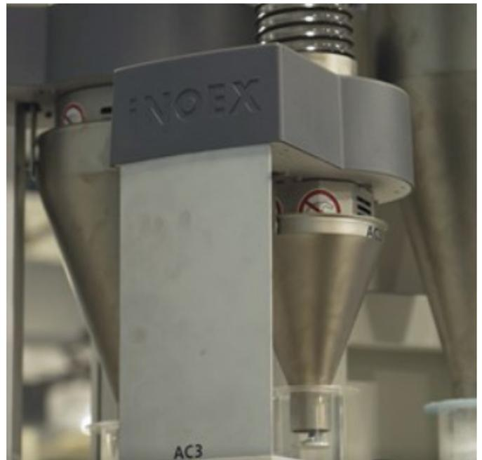
*Das gravimetrische Dosiersystem sorgt für eine präzise Dosierung und seine Steuerung spielt eine wesentliche Rolle bei der Systemintegration.*
