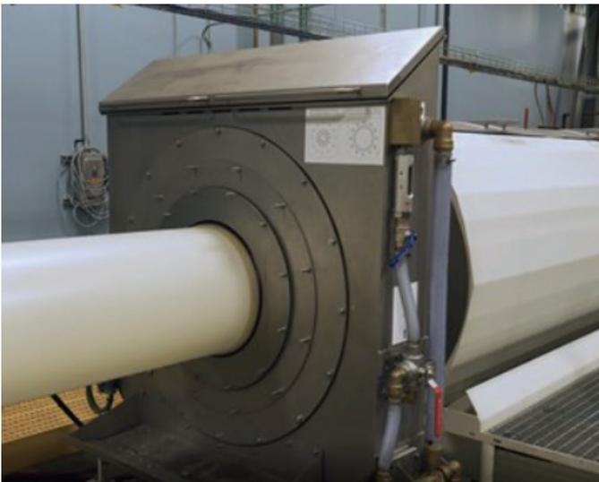
iNOEX超声波测量系统安装在真空箱的后面。它提供精确的尺寸数据，然后反馈给闭环控制系统。
